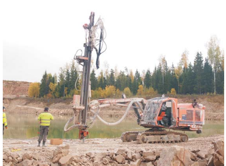
Foto 8. Dolomiidi lõhkamiseks aukude puurimine
